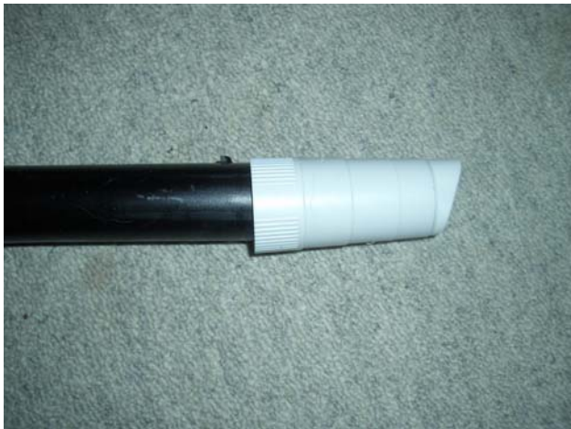
Abbildung 2: Mitest Dust Collector ® mit eingesetztem Filter an Staubsauger angeschlossen.
